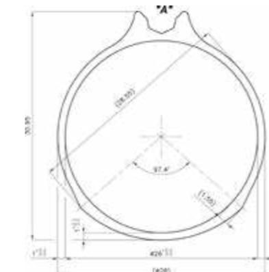
Tubo Nemesis in alluminio lega 6005-T6, con guida asta per una maggiore precisione, nella parte inferiore sono presenti due nervature per aumentare la resistenza alla torsione del tubo.
